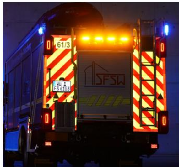
28. Ábra: A német szabvány szerinti fényvisszaverő és a figyelemfelkeltő lámpák sötétben (forrás: szakirodalom - Verkehrsabsicherung von Einsatzstellen der Feuerwehr)
