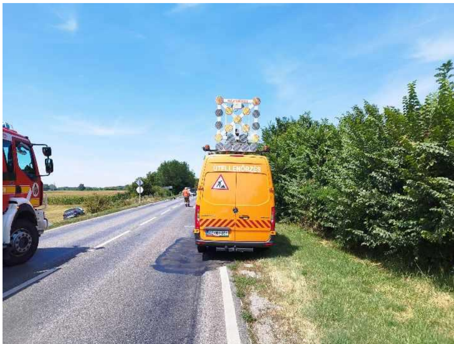
20. Ábra: Járműre szerelt terelő fényrendszer, mely útlezárást mutat (forrás: saját kép)
