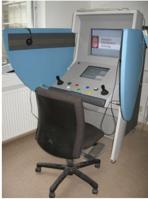
13.ábra A reakcióidők vizsgálására használt PÁV berendezés (forrás: https://m.blog.hu/ke/kezdokamionos/image/5.%20bejegy%20-%20P%C3%81V/5.bejegy_pav_gep.jpg )
