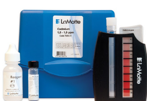
(a) Tesztkészlet kadmium detektálására [6].
