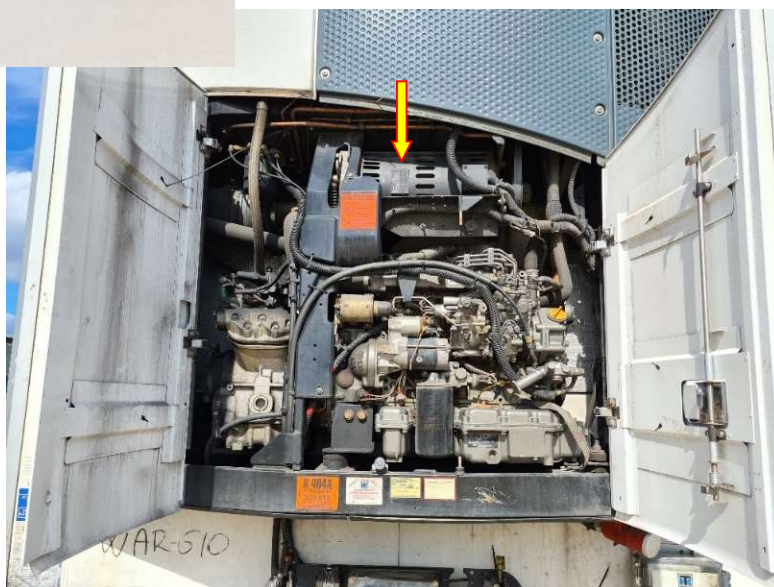
4.3. ábra Thermo King hűtőrendszere, és a beépített SLX motorház
