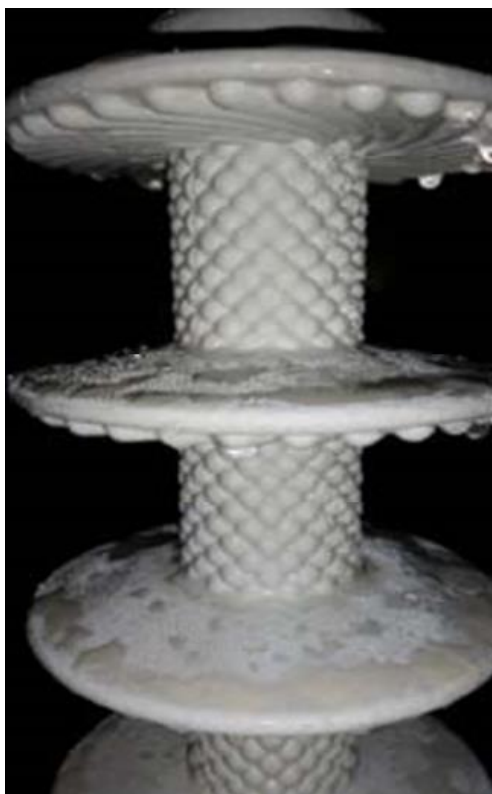
1.4. ábra - Egy texturált felületű szigetelő nedvesítés közben [1]
