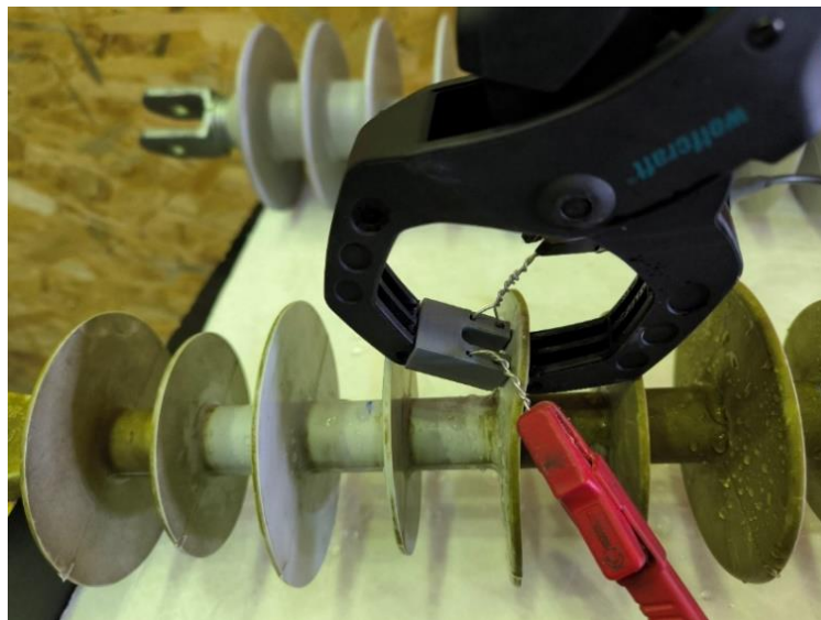
3.4. ábra - A szigetelő felületére rögzített mérőeszköz
