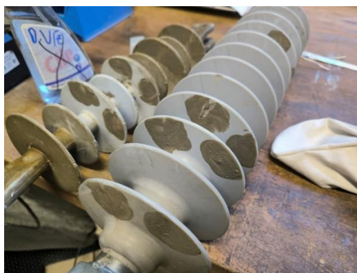
4.3. ábra - A cementtel történő szennyezés folyamata
