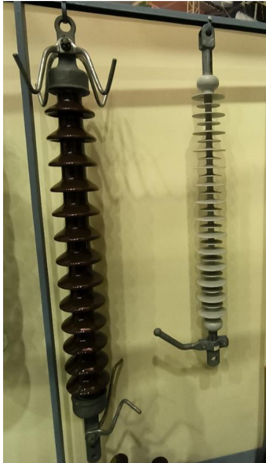
1.3. ábra - Kerámia szigetelő (balra) és kompozit szigetelő (jobbra)
