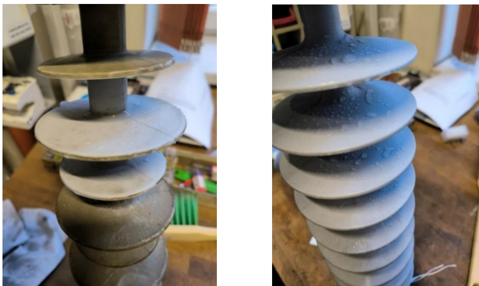
3.7. ábra - Az 1-es és 2-es számú szigetelők hidrofbocitása a tisztítás után (2-es szigetelő képen látható harmadik ernyője már tisztítatlan)
