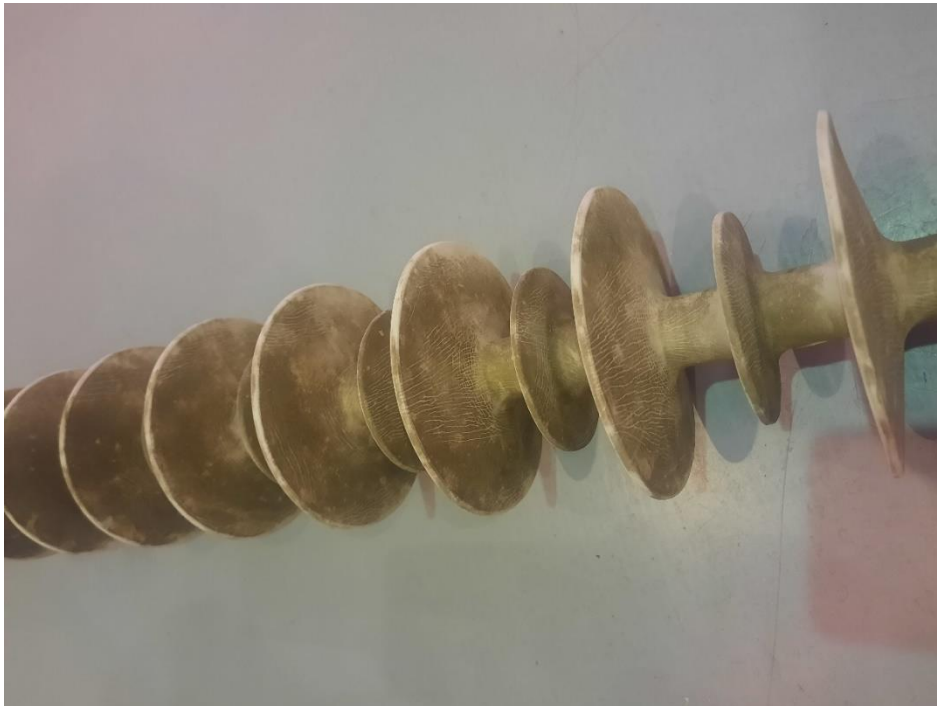
2.2. ábra - Egy szennyezett kompozit szigetelő
