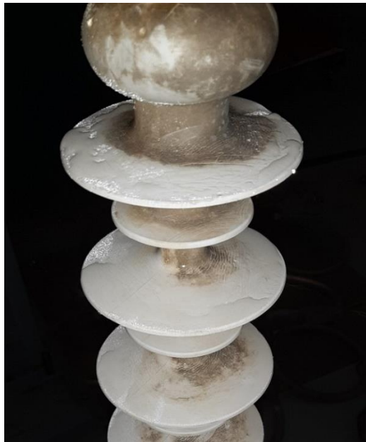
2.1. ábra - Egy NaF kompozit szigetelő felülete nedvesség hatására
