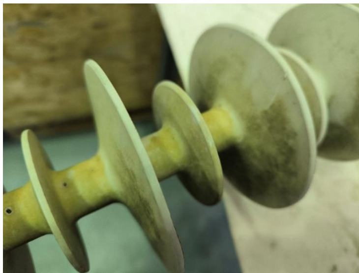
4.7. ábra - A téglaporos szigetelő
