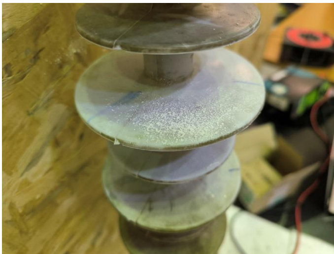
4.2. ábra - Az 1-es számú szigetelő kaolinnal szennyezve
