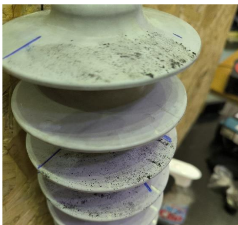
4.6. ábra - A felületre szórt fémpor a felesleg eltávolítása előtt
