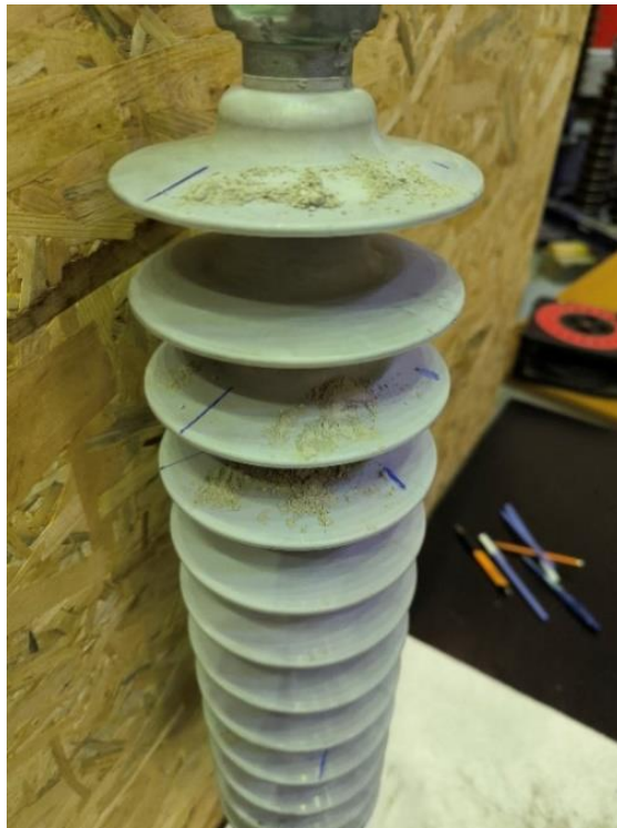
4.5. ábra - A szigetelő felületére szórt cementpor
