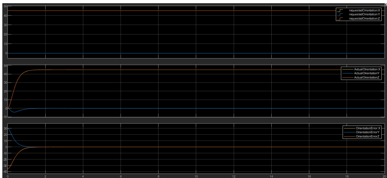
10. ábra: Szabályzó működése 100 Kg terhelés mellett – beállási idő 2 másodperc
