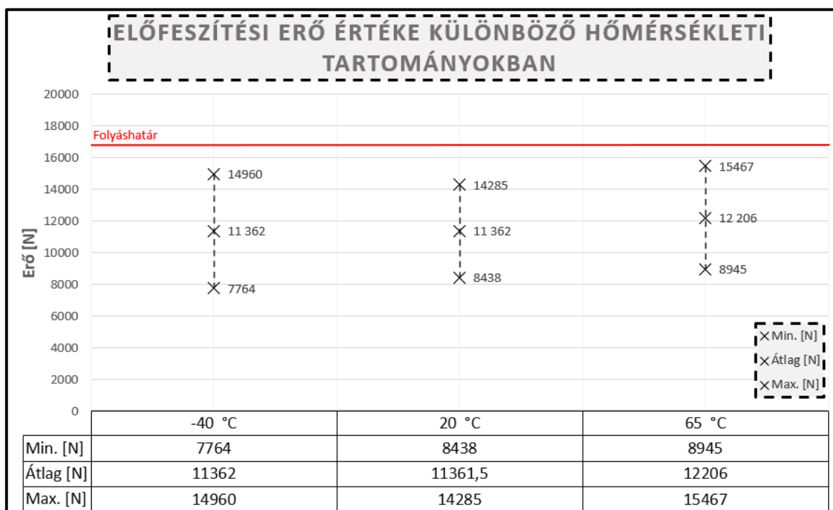
11.ábra: az előfeszítési erő értéke különböző üzemállapotokban
