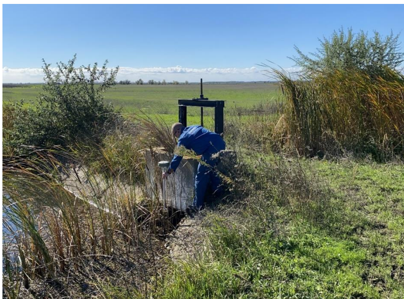
3. fénykép: NK-III-2-6. fűrtcsatorna 6+060 (cskm) szelvényben található műtárgy küszöbszintjének bemérése
