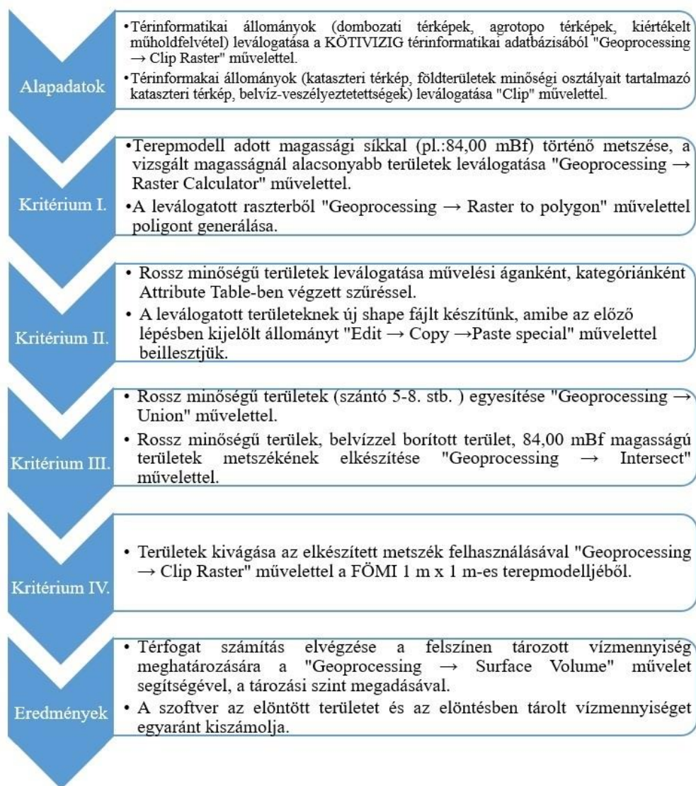
5. ábra: ArcGIS térinformatikai szoftverben lefuttatott vizsgálat folyamatábrája saját szerkesztés
