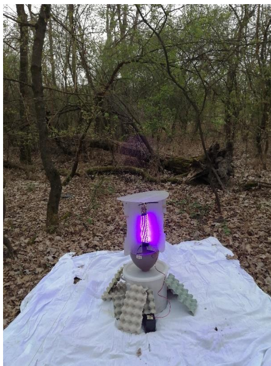
5. ábra: A mintavételek során alkalmazott vödörcsapda, led szalag fényforrással
