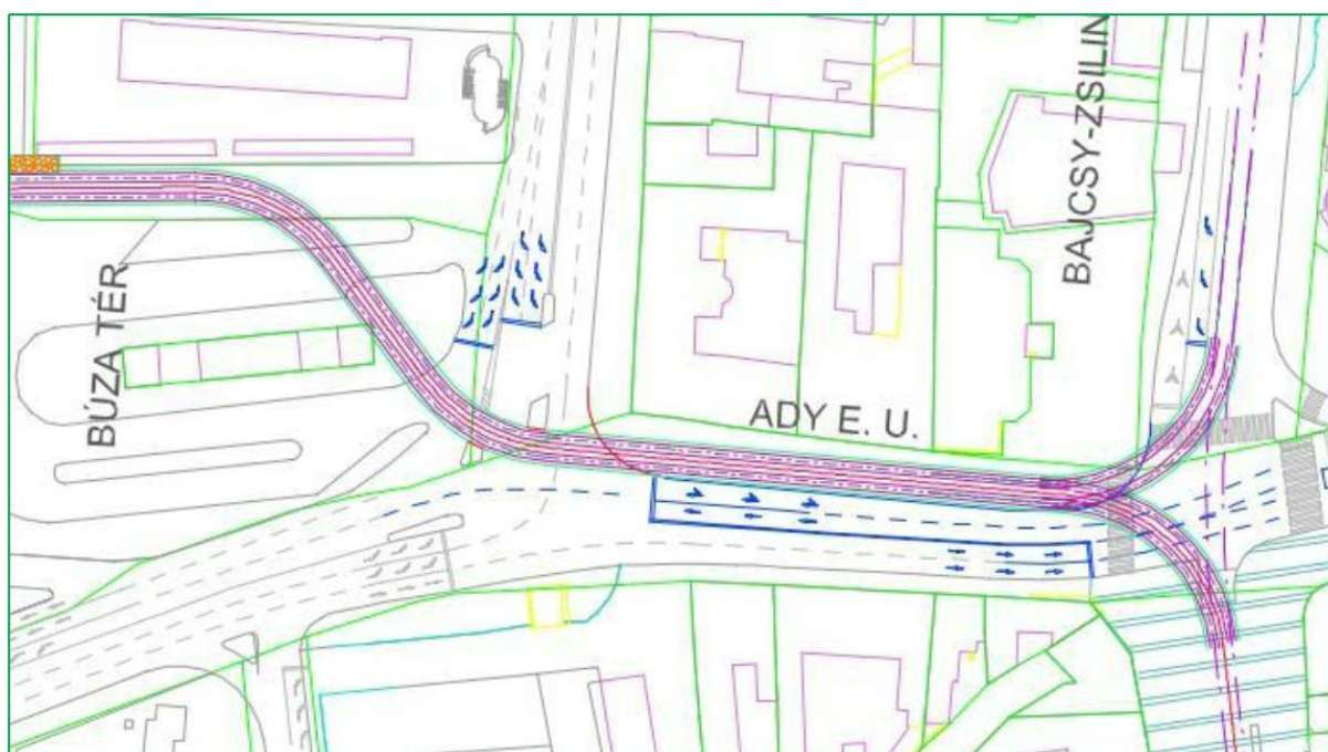
15. ábra: A Búza tér vágánykapcsolata a K–Ny-i vonalhoz (forrás: Szolgáltatói javaslatok a Miskolc, észak–déli villamosvonal tanulmánytervéhez. MVK Zrt., 2022)
