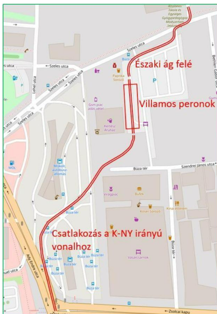
14. ábra: A villamos vonalvezetése és a peronok elhelyezése a Búza téren
