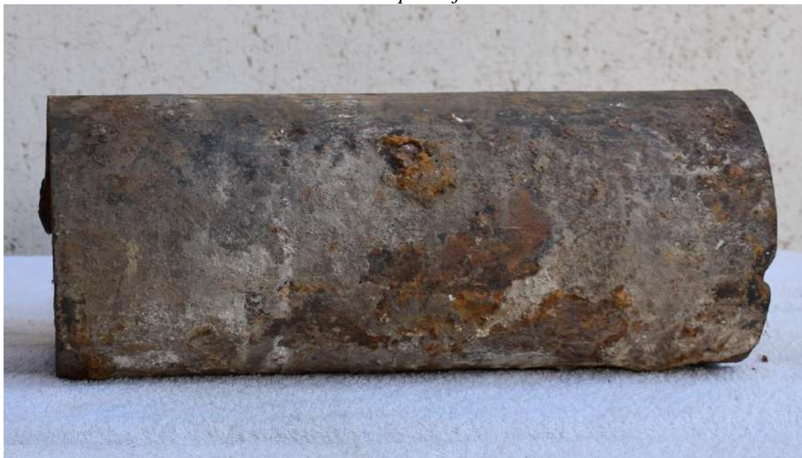
73. számú melléklet: 6. számú munkadarab belső csőfala és keresztmetszetének részlete szemből
