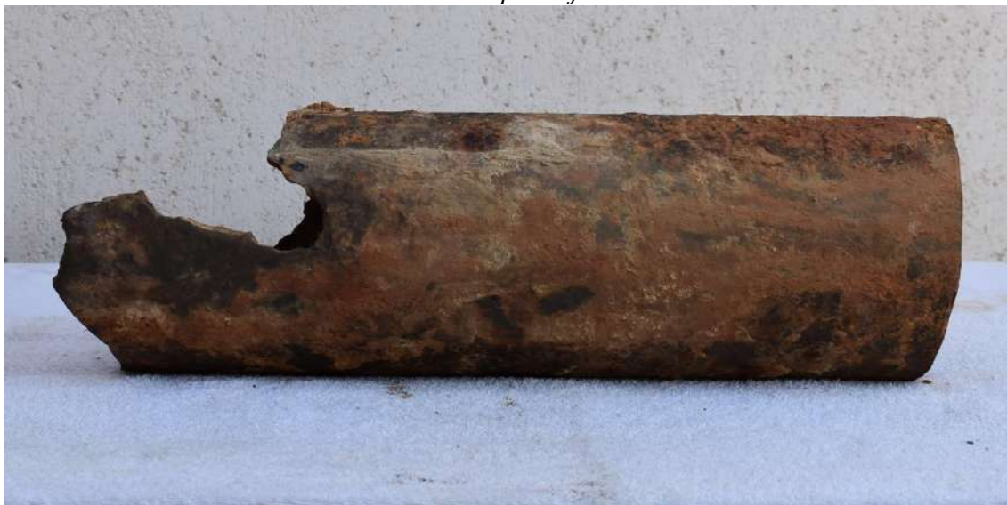
60. számú melléklet: 5. számú munkadarab belső csőfala és keresztmetszetének részlete szemből
