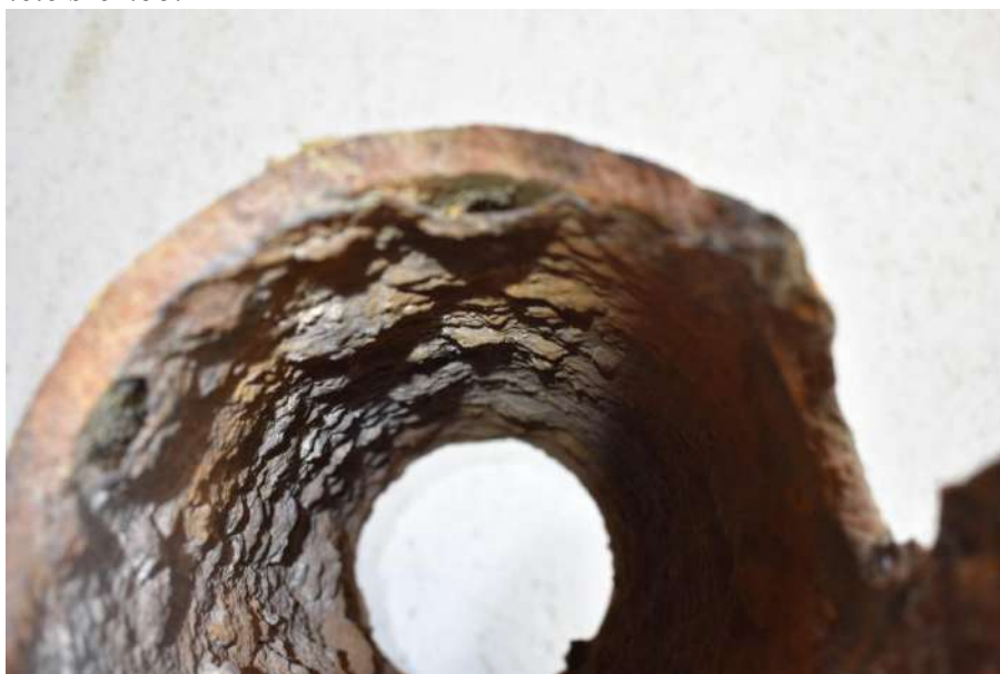
60. számú melléklet: 5. számú munkadarab belső csőfala és keresztmetszetének részlete szemből
