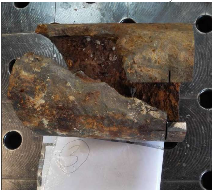
38. számú melléklet: 3. számú mintadarab hosszirányú metszet
