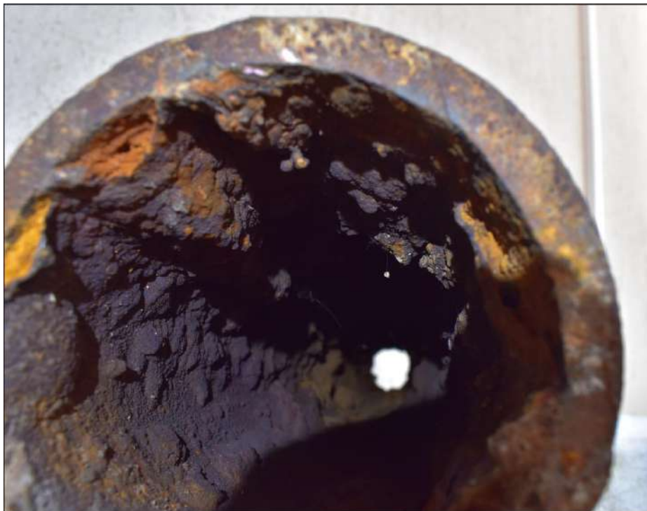
97. számú melléklet: 8. számú munkadarab belső csőfala és keresztmetszetének részlete szemből
