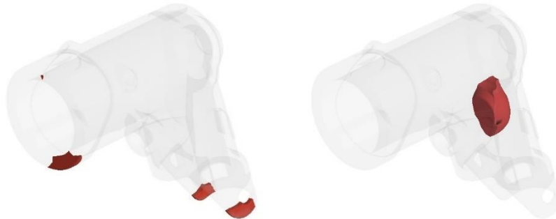
26. ábra. bal) Először és jobb) utoljára dermedő öntvényrészek
