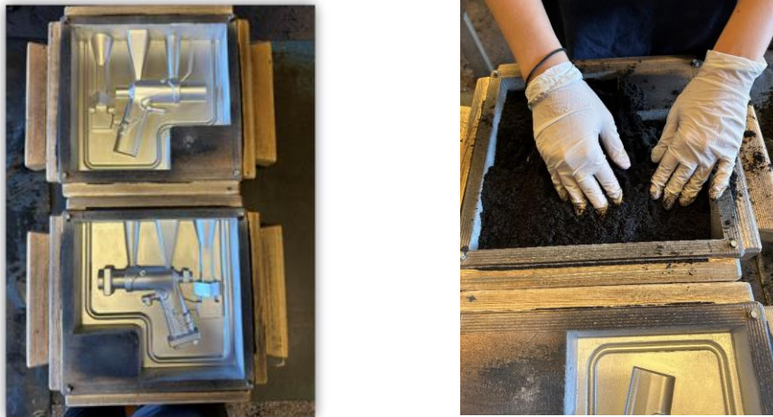
32. ábra. Mintalap és a kézi formázás folyamata
