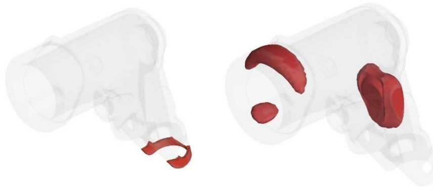
11. ábra bal) először dermedő, jobb) utoljára dermedő részek
