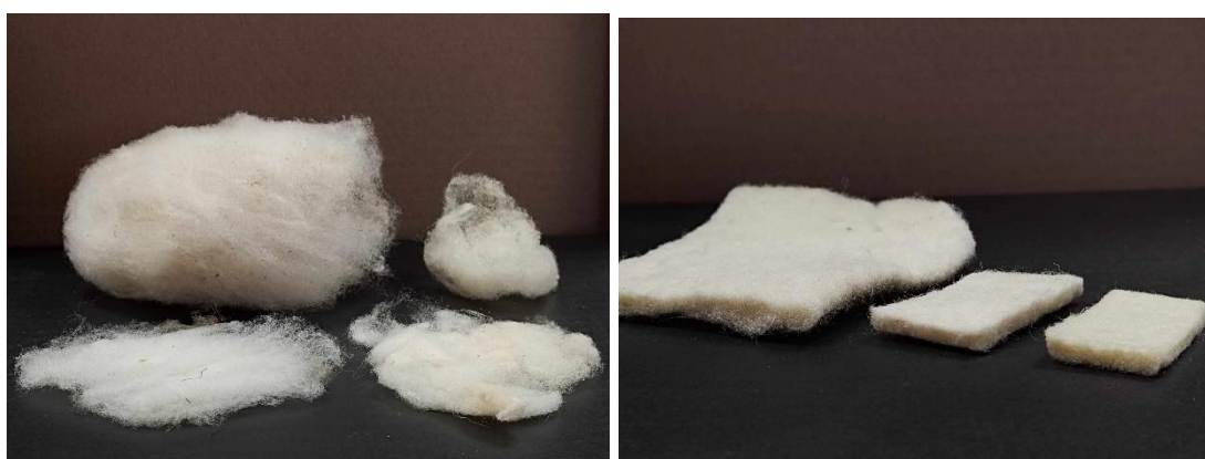
14. ábra Maradó alakváltozás mérése kártolt és nemezelt gyapjún
