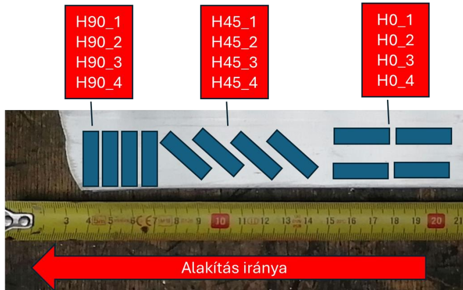
8. ábra Mintavételezése és jelölés a hengerelt próbatestből
