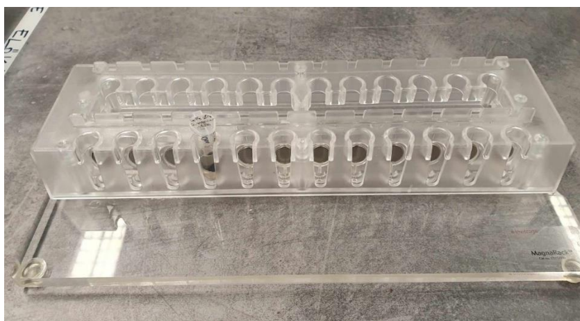
9. ábra Mágneses tartó: Eppendorf-csöveket belehelyezve lehetővé teszi a MNP-k és a felülúszó folyadék elválasztását
