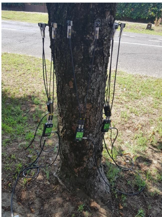
8. ábra Piezo érzékelők és az erősítő dobozok
