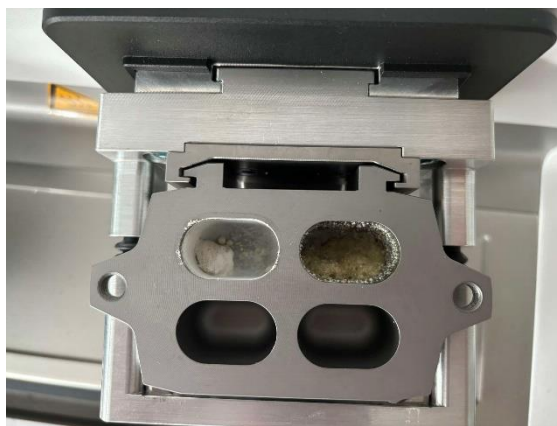
37. ábra: Oszcilláló golyósőrlő RETSCH MM 500 nano - balra, 10 ml-es kamra reagensekkel 45 perc után - jobbra.
