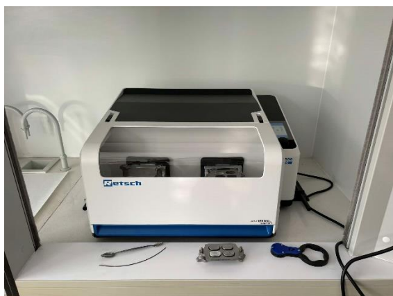
37. ábra: Oszcilláló golyósőrlő RETSCH MM 500 nano - balra, 10 ml-es kamra reagensekkel 45 perc után - jobbra.
