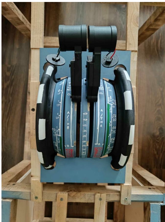
Ábra 8: Airbus A320 megvalósított Trim indikátor [12]
