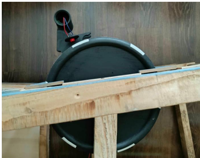
Ábra 7: Airbus A320 megvalósított Trim kerék [12]
