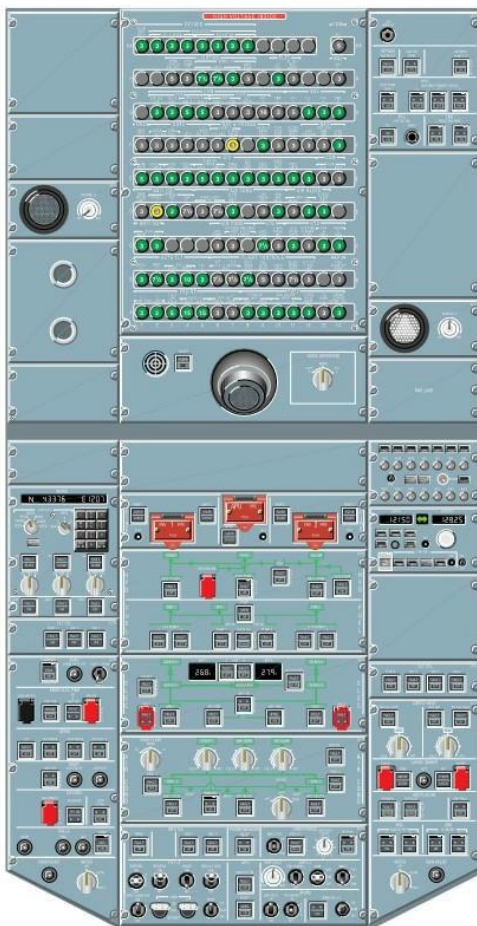
Ábra 13: Airbus A320 Felső vezérlőpanel [15]
