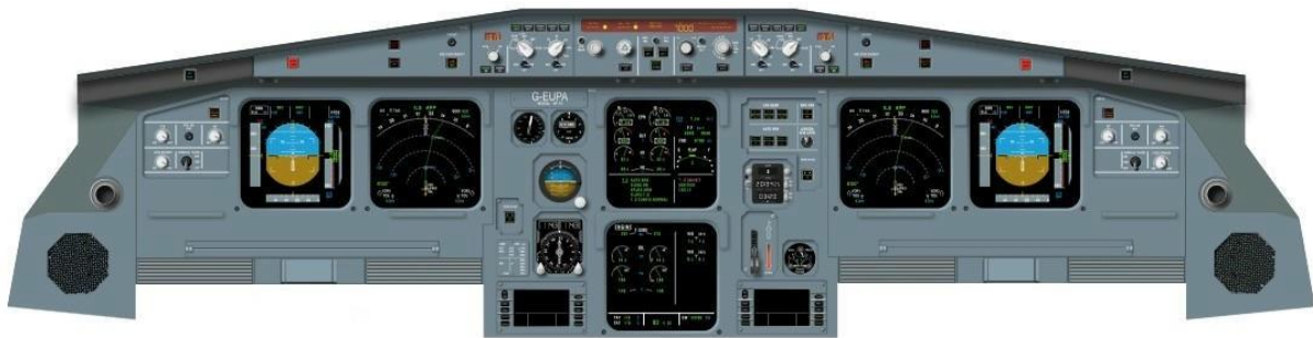
Ábra 12: Airbus A320 Elülső vezérlőpanel [14]
