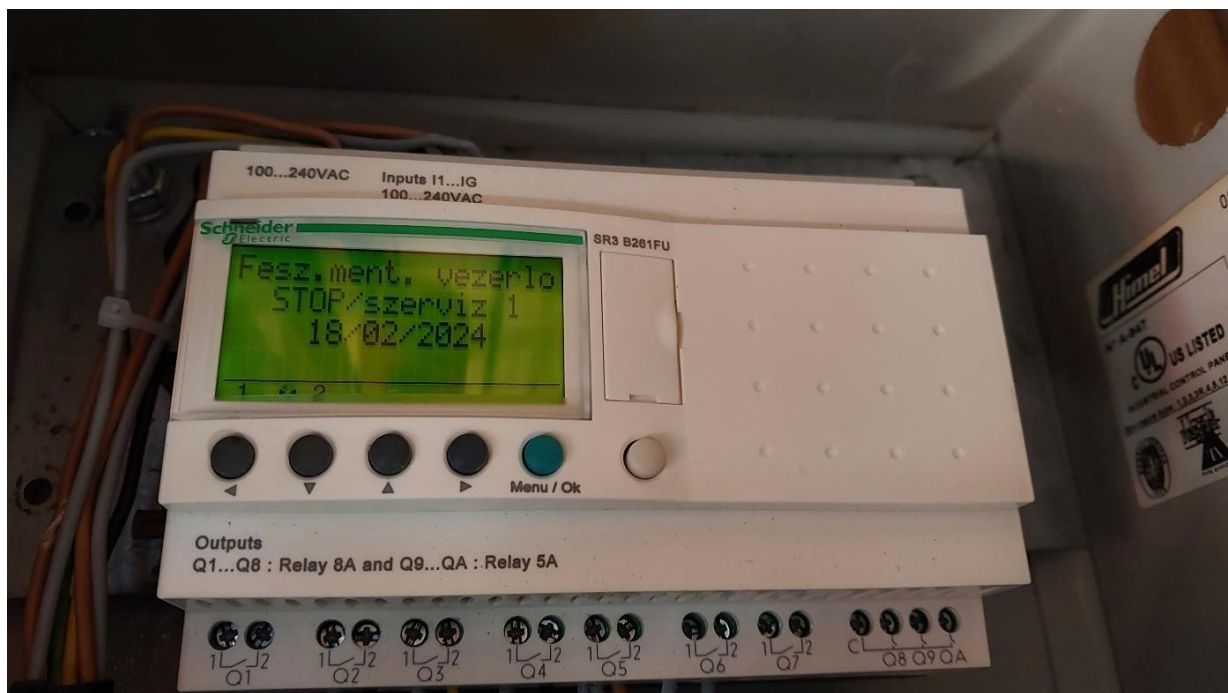
29. ábra PLC STOP/Szerviz funkció (saját kép)
