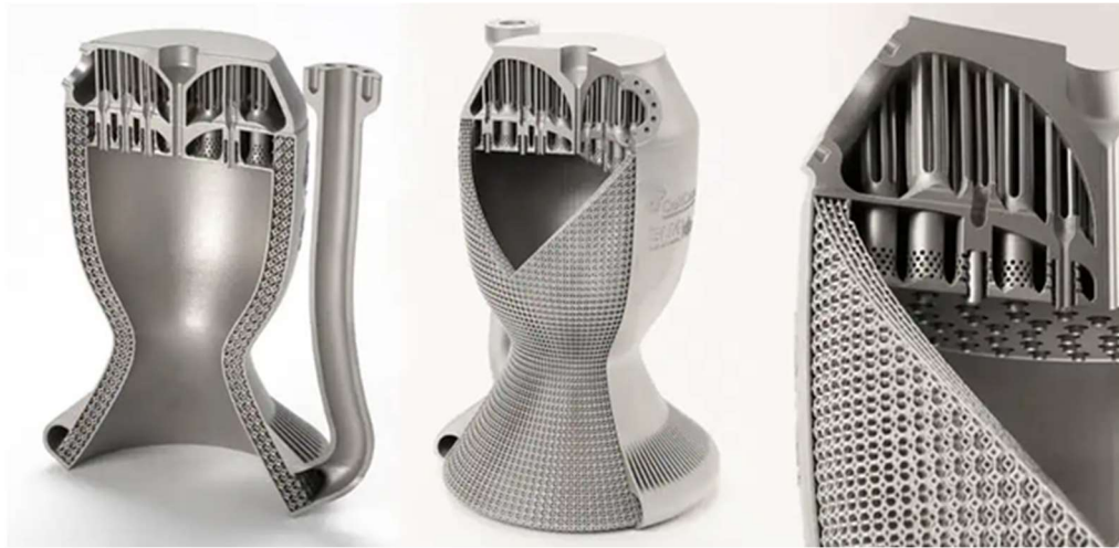
5. ábra: SLM technológiával gyártott rakétahajtómű égéstér [8]
