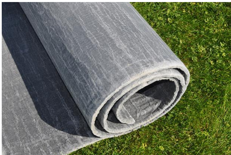
6.ábra: SPACELOFT aerogél hőszigetelő paplan [17]
