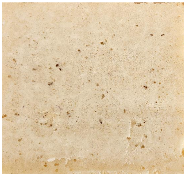
18.ábra: PATTEX Univerzális kézi poliuretán hab segítségével aerogéllal kevert kifújt minta
