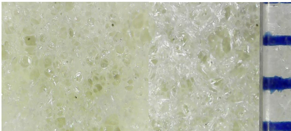
28.ábra: Aerogéllal kevert PATTEX Univerzális poliuretán hab felülnézeti mikroszkópos felvétele
