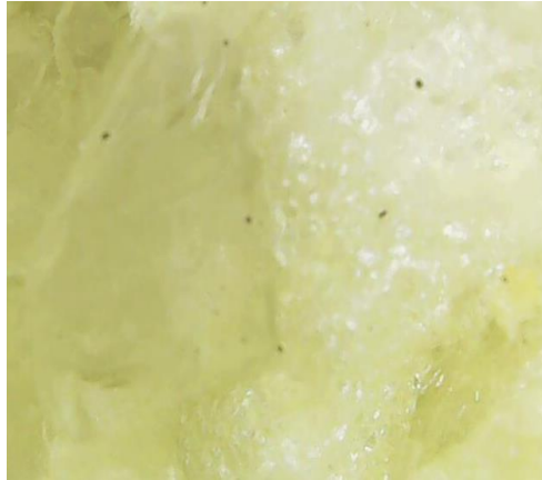
35. ábra: Magasnyomású szórógép segítségével 2. módszer szerint kifűjt poliuretán hab belsejébe ágyazódott kwark aerogél granulátum
