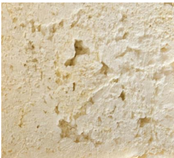
24.ábra: Magasnyomású szórógép segítségével 2. módszer szerint kifűjt, aerogéllal kevert poliuretán hab minta
