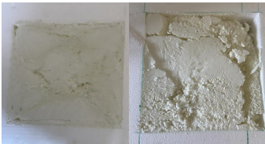
13.ábra: A keretekbe fűjt sima poliuretán és aerogéllal kevert poliuretán minták száradás után
