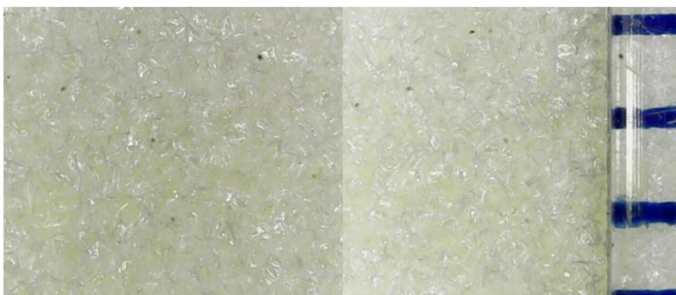
33.ábra: Magasnyomású szórógép segítségével 2. módszer szerint kifűjt poliuretán hab felülnézeti mikroszkópos felvétele
