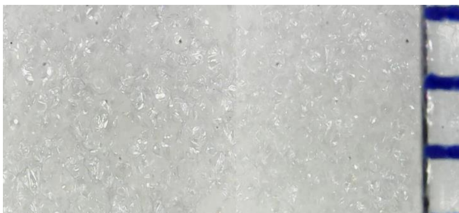
30.ábra: Magasnyomású szórógép segítségével 1. módszer szerint kifűjt poliuretán hab felülnézeti mikroszkópos felvétele
