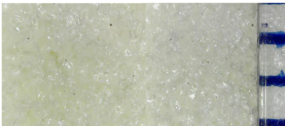
34.ábra: Magasnyomású szórógép segítségével 2. módszer szerint kifűjt, aerogéllal kevert poliuretán hab felülnézeti mikroszkópos felvétele
