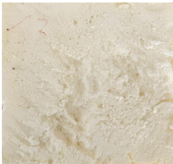
21.ábra: Magasnyomású szórógép segítségével 1. módszer szerint kifújt, aerogéllal kevert poliuretán hab minta
