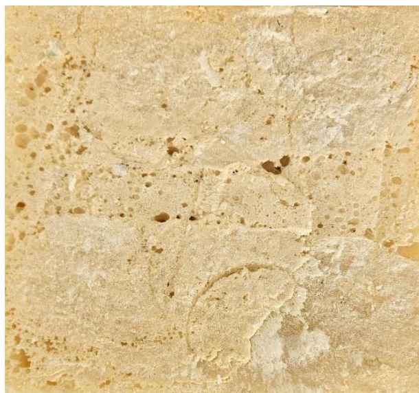
17.ábra: PATTEX Univerzális kézi poliuretán hab segítségével kifűjt minta
