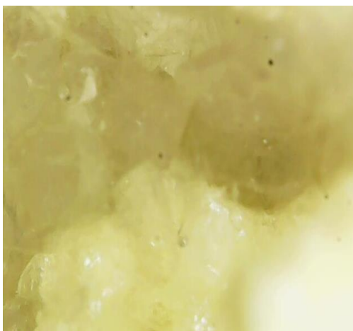
29.ábra: PATTEX Univerzális kézi poliuretán hab minta belsejébe ágyazódott kwark aerogél granulátum
