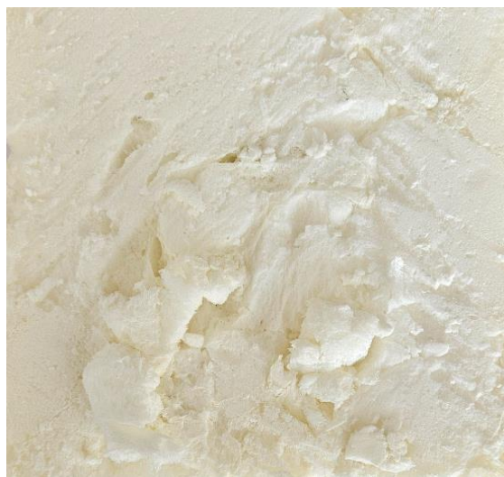
20.ábra: Magasnyomású szórógép segítségével 1. módszer szerint kifűjt poliuretán hab minta
