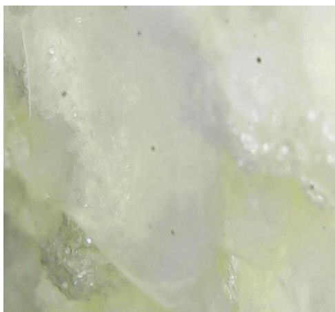
32.ábra: Magasnyomású szórógép segítségével 1. módszer szerint kifűjt poliuretán hab minta belsejébe ágyazódott cabot aerogél granulátum
