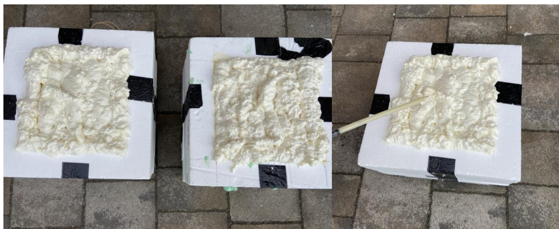
12.ábra: A keretekbe fűjt sima poliuretán és aerogéllal kevert poliuretán minták
