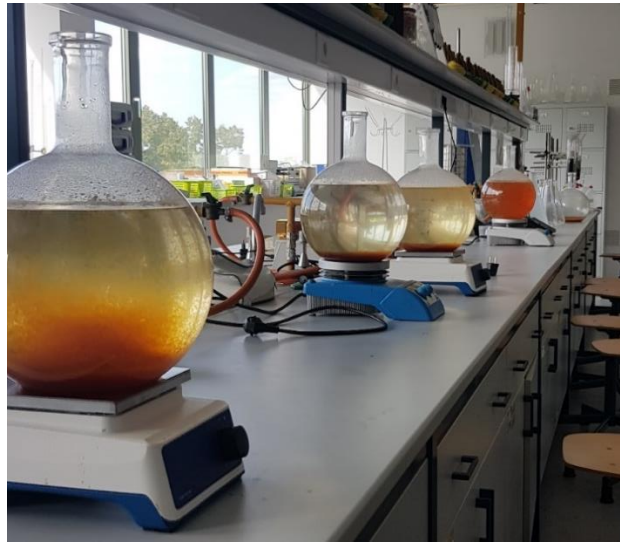
5. ábra: Koagulációs-flokkulációs kémiai kezelés (saját kép)
