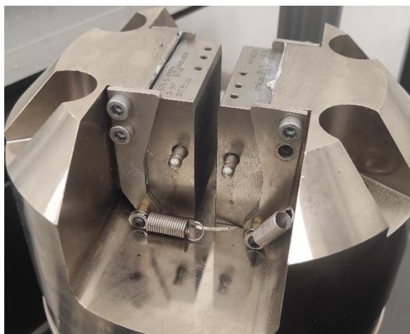
27. ábra A húzóvizsgálathoz alkalmazott ékpályás szorítószerszám
