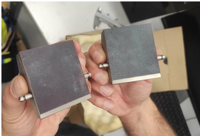
26. ábra A próbatestek geometriai méreteink megfelelő ékpályás szorítású befogópofák
