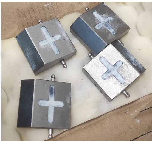
26. ábra A próbatestek geometriai méreteink megfelelő ékpályás szorítású befogópofák
