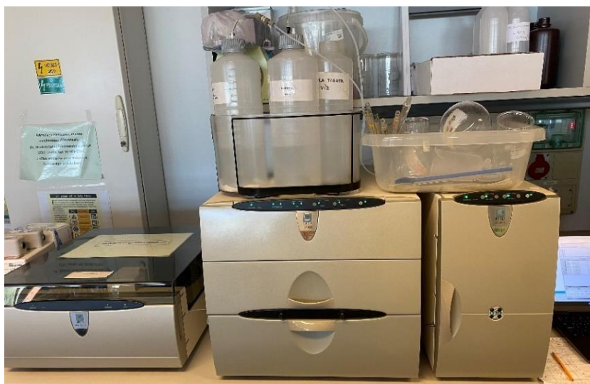
15. ábra DIONEX ICS-3000 dual ionkromatográfiás rendszert (saját fotó)
