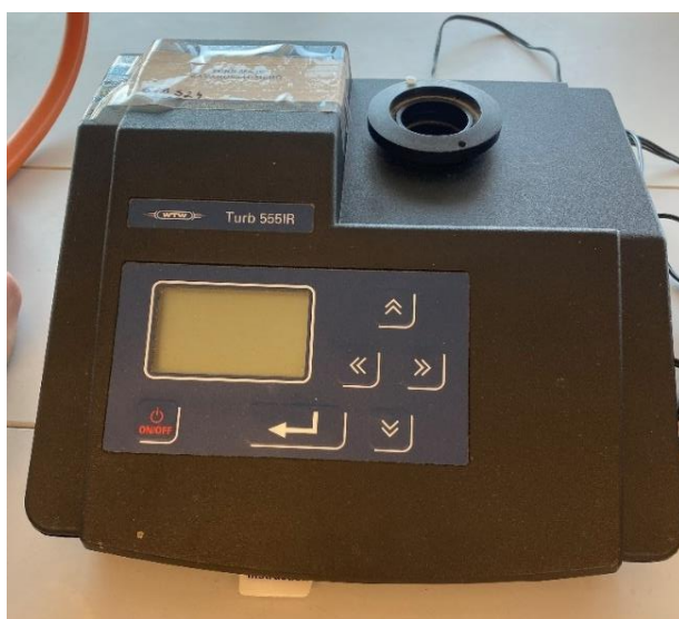
10. ábra Turb 555-IR típusú zavarosságmérő (saját fotó)
