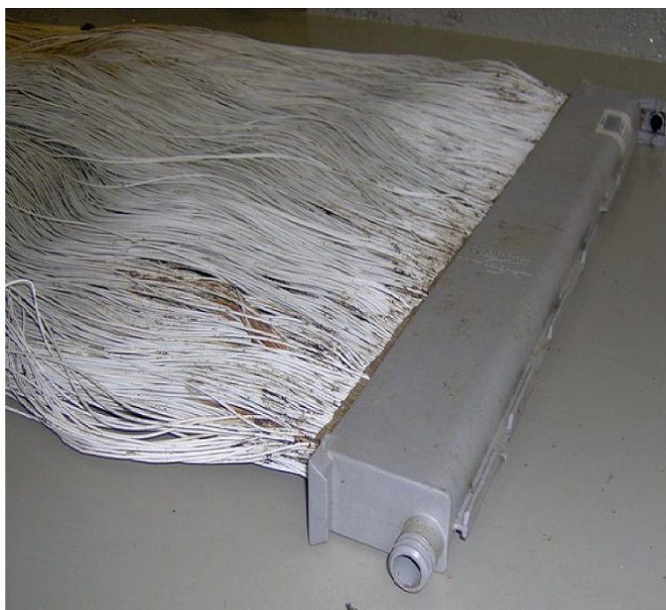
27. ábra Membrán technológia membrán modul eleme Karcagon
