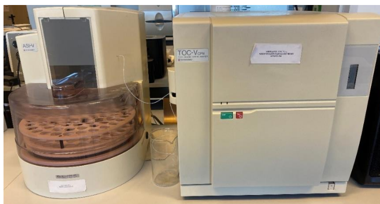
13. ábra Shimadzu TOC-V CPN típusú berendezés (saját fotó)
