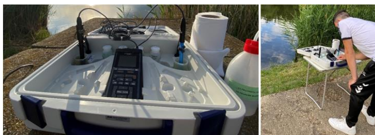
9. ábra MultiLine P4 típusú mérőbőrönd használata terepen (saját fotó)
