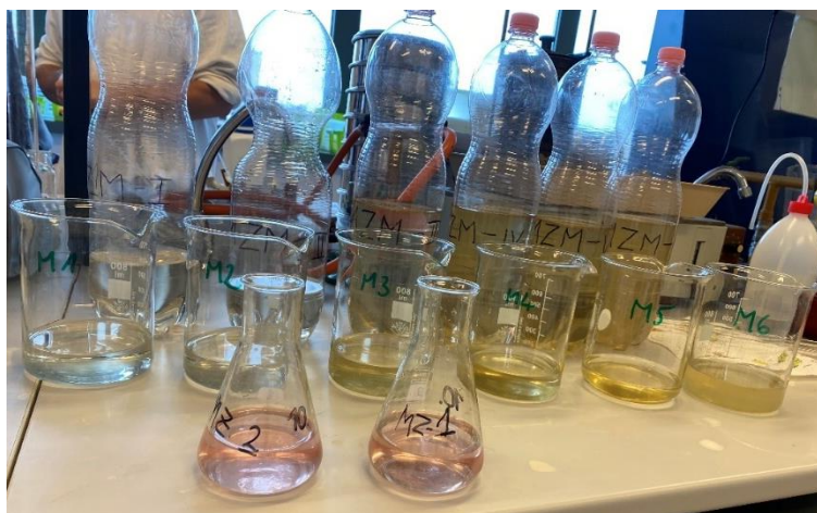
14. ábra Lúgosság meghatározása titrálással (saját fotó)
