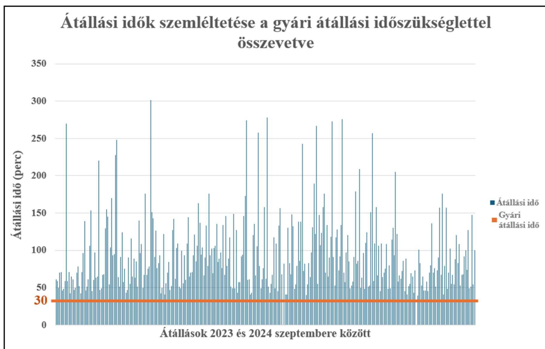
5. ábra átállási idők összehasonlítása a gyártói idővel - Saját szerkesztés [17] alapján
