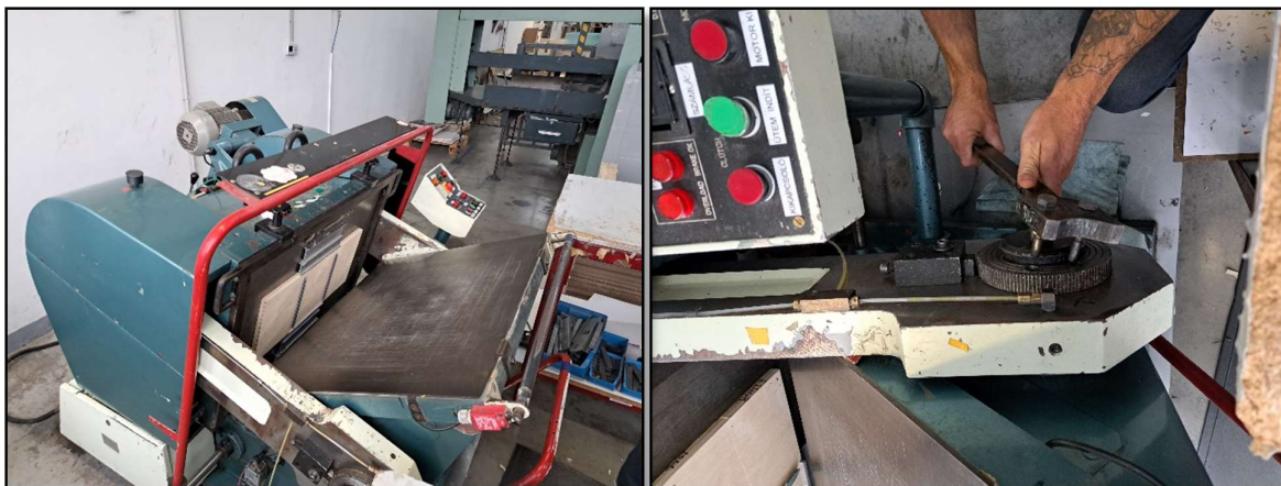
14. ábra B1 kézi stancológép átállás és nyomás állítás - Saját kép (2024)
