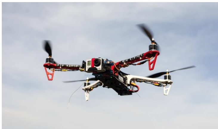
3. ábra: Egy DIY kvadkopter kamerával felszerelve [18]
