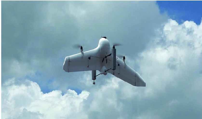
4. ábra: Egy tail-sitter UAV prototípus [24]
