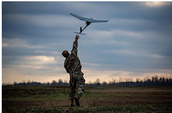
2. ábra: Hordozható katonai UAV kézi indítása [12]
