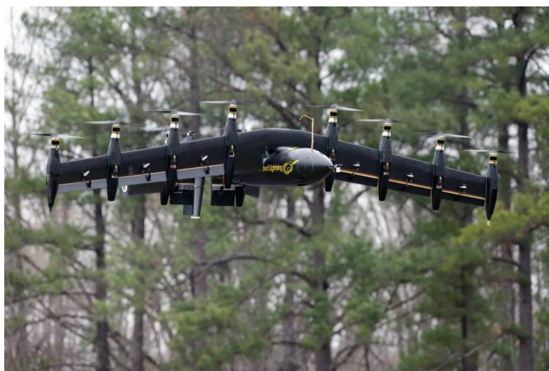
5. ábra: NASA GL-10 dönthető szárnyú UAV [28]
