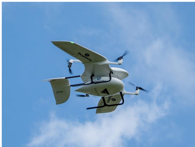
6. ábra: Wingcopter 178 dönthető légszárnyú szállító UAV repülés közben [30]
