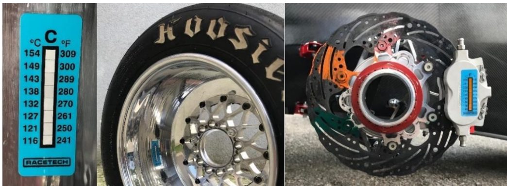
Figure 22 Hőmérséklet mérések a keréken és az első tengelyen [15]
