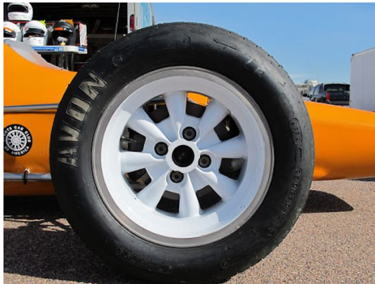
Figure 3 Egy veterán nyitott kerekű versenyautón használt acél versenykerék [7]
