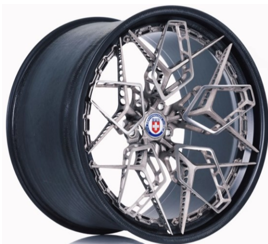
Figure 6 2 részes keréktárcsa 3D nyomtatott titán centerrel és CFRP külsővel [11]
