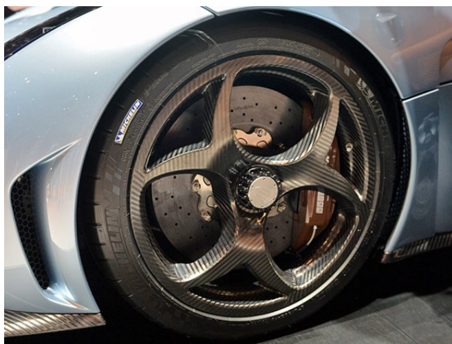
Figure 7 A Koenigsegg Regera egy részes, CFRP keréktárcsája [12]
