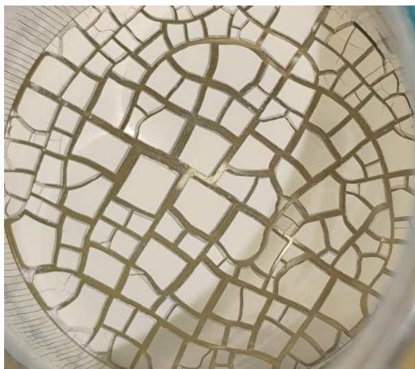
3. ábra: Felületaktivált titán-dioxid töredezett felülete.
