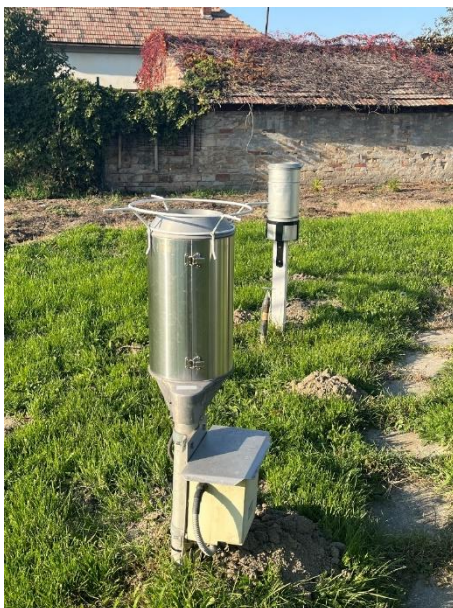
9. ábra: A manuális csapadékmérő műszer a mosonmagyaróvári meteorológiai állomáson (forrás: Zseni Anikó fotója)
