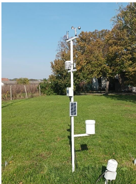
10. ábra: Az automata meteorológiai állomás, benne a csapadékmérő műszerrel a mosonmagyaróvári meteorológiai állomáson (forrás: saját fotó)
