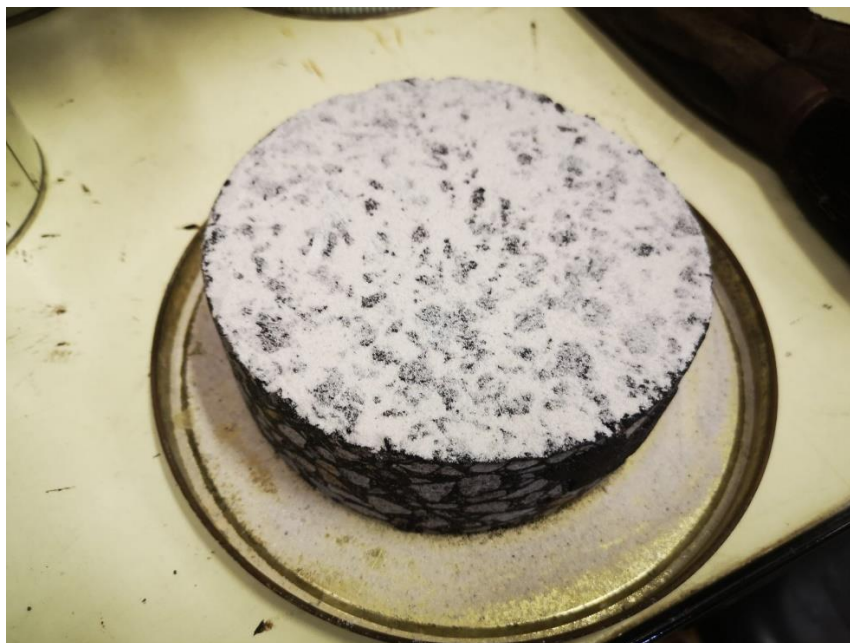
45. ábra: Visszamérés elvű hagyományos makro érdesség vizsgálat
