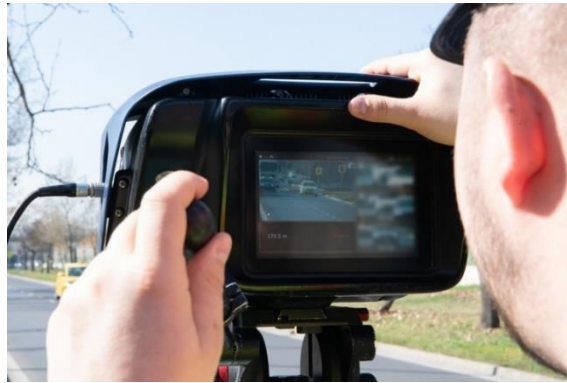
20.ábra: Lézeres sebességmérés az út szélén a közlekedési hatóság kollégája által 22
