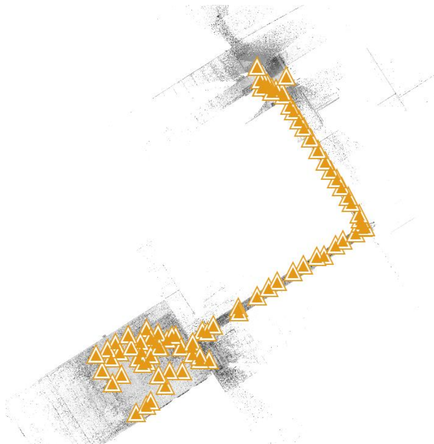
3. ábra. Egymáshoz illesztett pontfelhők egy energia központban
