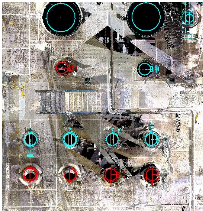
4. ábra. Egy 3D-ben modellezett fűtésechnikai osztógyűjtő és a hozzátartozó pontfelhő
