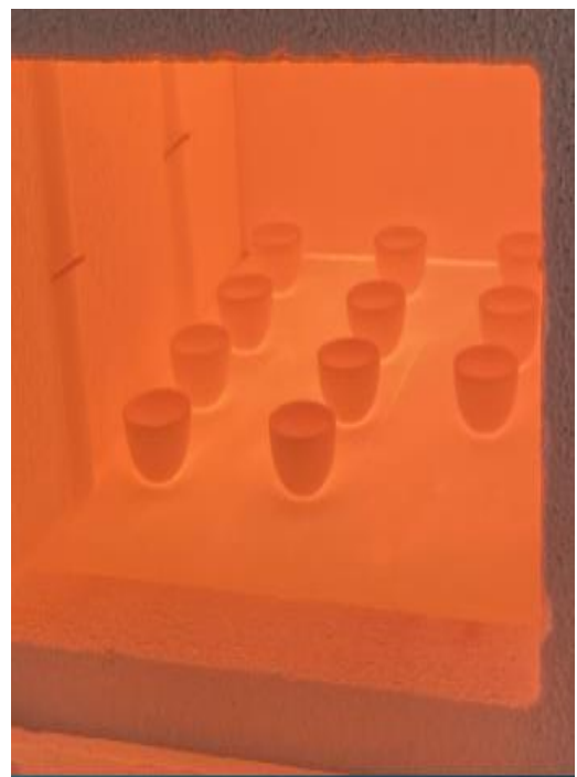
6.kép. Üledékminták izzítása a kemencében 950°C-on.
