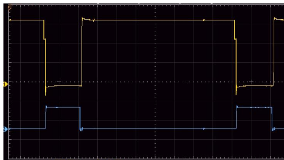
73. ábra. \sim 350\text{ ns} holtidő 1K \Omega -os ellenállás mellett
