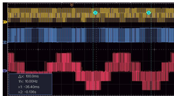
68. ábra. Háromfázis fázisfeszültség (CH1-CH2)
