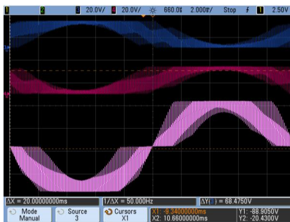
69. ábra. 20 KHz-es PWM, 50 Hz-es szinuszhullám, unipoláris moduláció (CH1-CH2)
