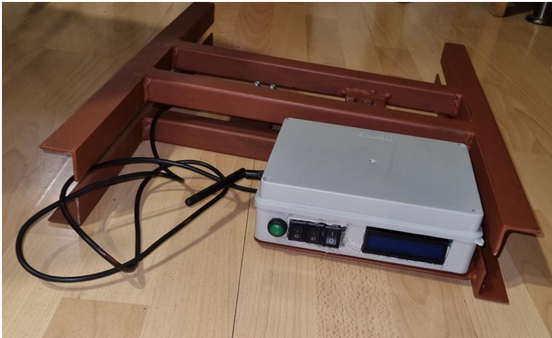
32. ábra. Az összeszerelt intelligens kaptármérő rendszer.
