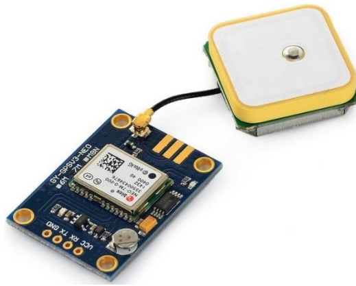
20. ábra. A NEO-6M GPS-modul [29]
