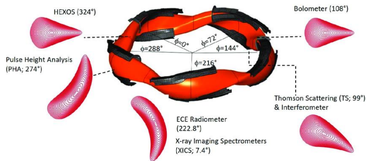
8. ábra: Diagnosztikai berendezések elhelyezkedése a W7-X sztellarátornál.
