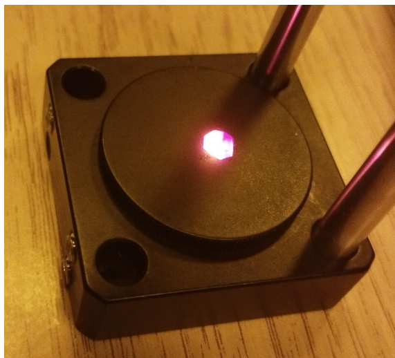
3. ábra. Fluoreszcencia egy NV centrumokban gazdag mintában. A kristály zöld lézerrel való gerjesztés hatására piros fényt bocsát ki. A visszaverődő zöld fényt egy a kamera elé helyezett védőszemüveg szűri ki.
