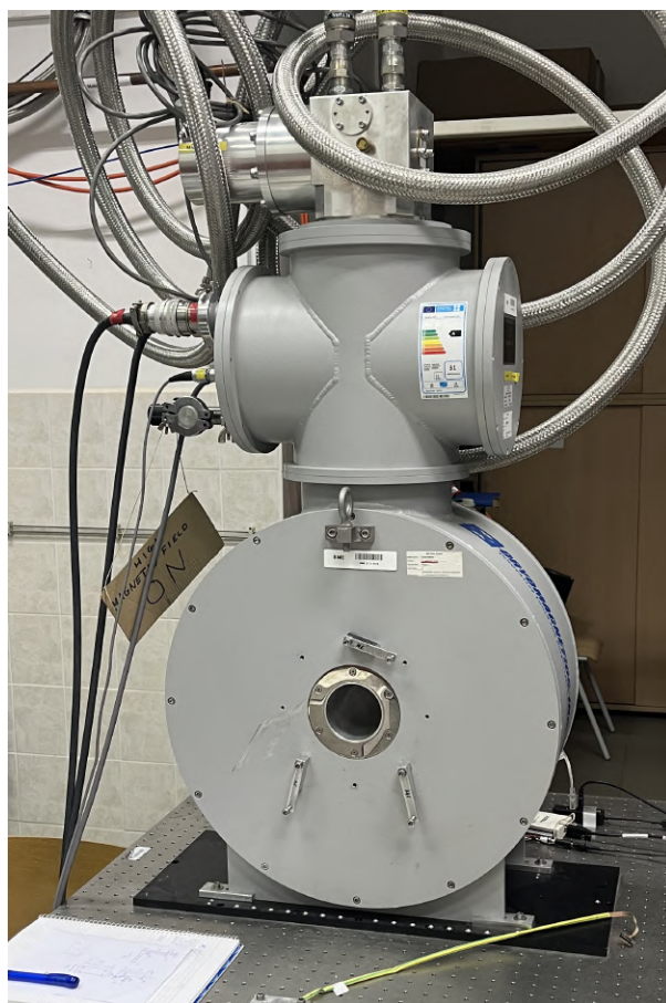
7.1. ábra. Janis állítható kriomágnes
