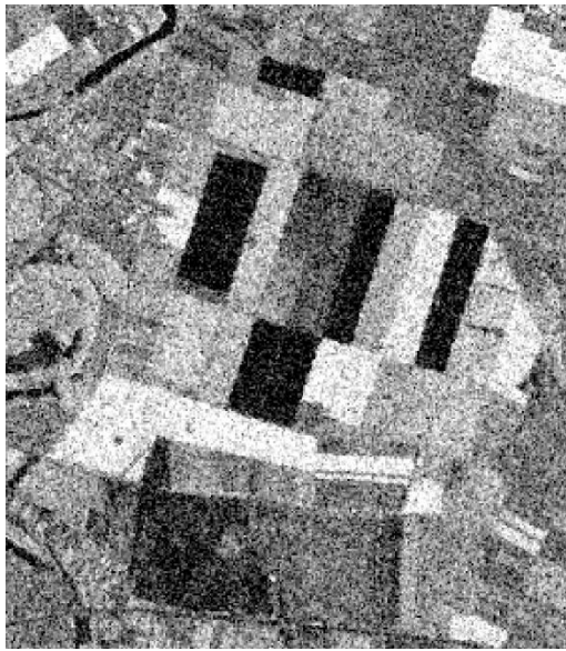
6. ábra: A Refined Lee szűrés hatása a radarfelvételekre. A szűrés előtti VV szórási együttható (balra) és a szűrt VV szórási együttható (jobbra).
