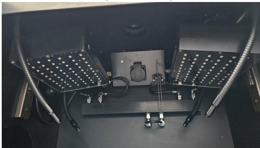
5.ábra: NightShade rendszer által használt CCD kamera rendszer
