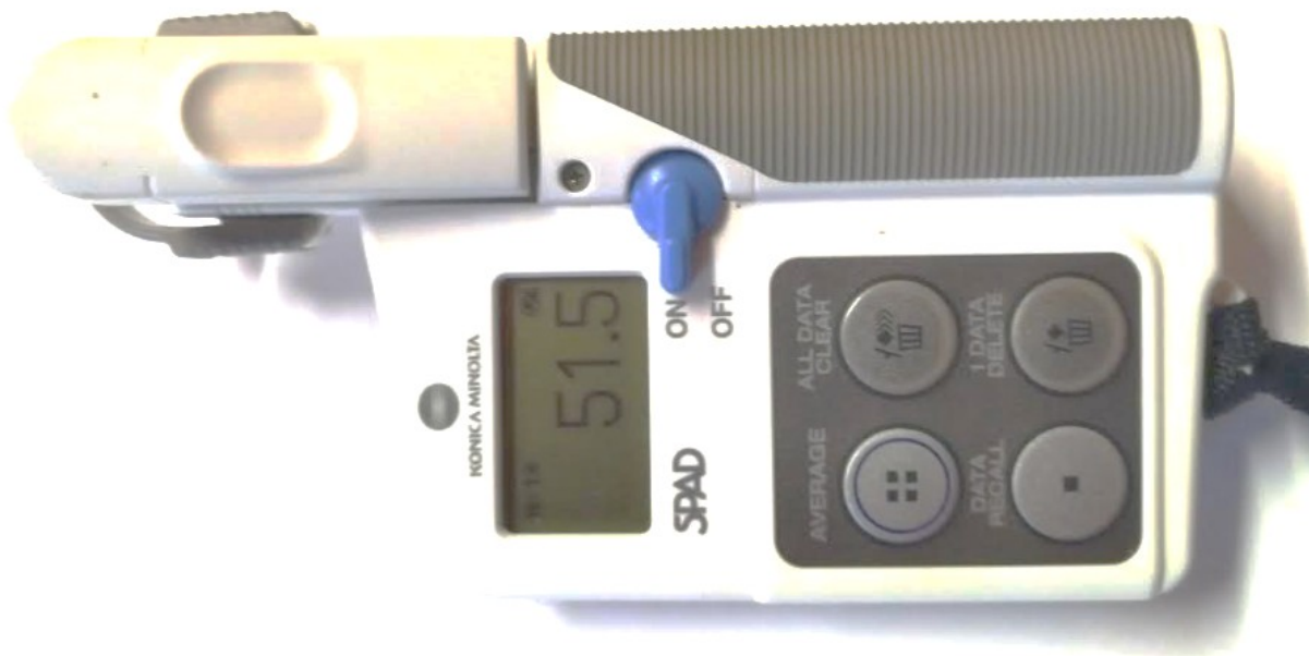
10. ábra: A fotoszintetikus aktivitás mérésére szolgáló SPAD készülék (fotó: Székér Kitti)
