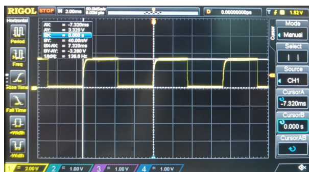
3.6. ábra. Az első kerékben elhelyezkedő Hall-szenzorok kimeneti jelének mérése
