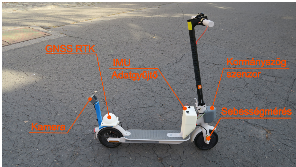
5.1. ábra. A szenzorokkal és mérésadatgyűjtő rendszerrel felszerelt elektromos roller
