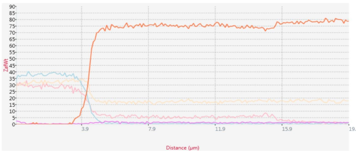
7. ábra A CRO bevonat elemanalízise a referencia mintán
