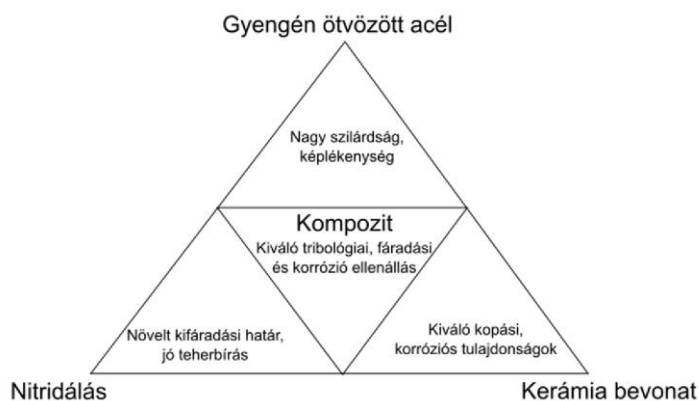
7. ábra: Nitridálással kombinált duplex kezelések hatásmechanizmusainak bemutatása [20]
