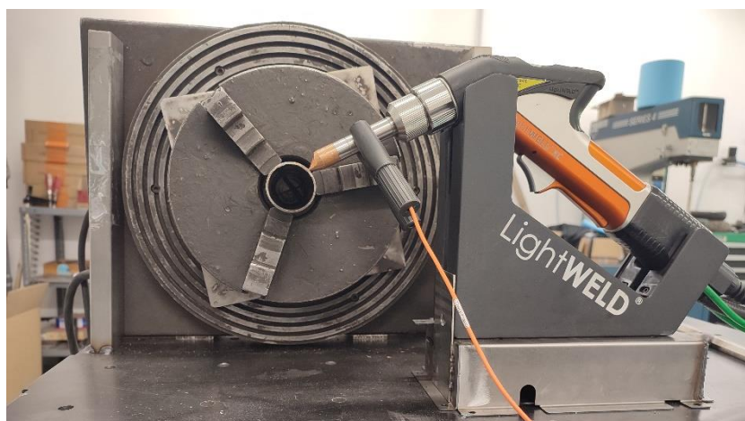
12. ábra: A forgató berendezés és a befogó készülék fényképe
