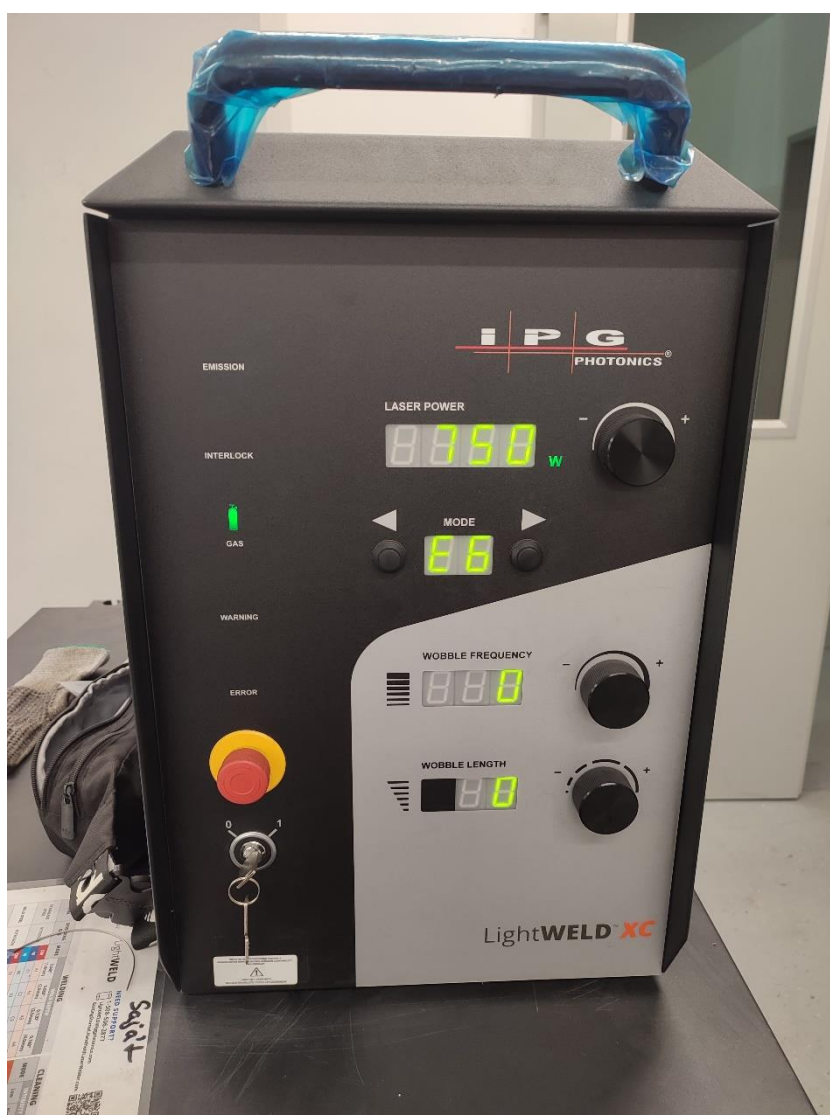
8. ábra: A kísérletekhez használt lézeres hegesztőgép
