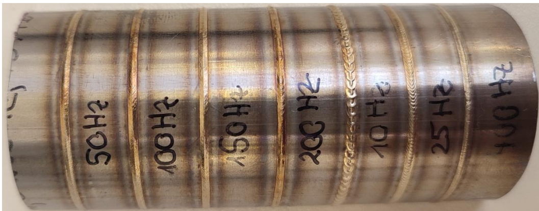
15. ábra: Az impulzusfrekvencia változtatása mellett készített varratok fényképe, a beállított impulzusfrekvencia balról jobbra 50 Hz, 100 Hz, 150 Hz, 200 Hz, 10 Hz, 25 Hz, valamint 400 Hz
