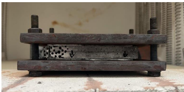
15. ábra Szintaktikus fémhab szendvicsszerkezetek forrasztása közben alkalmazott, leszorítást biztosító szerkezet
