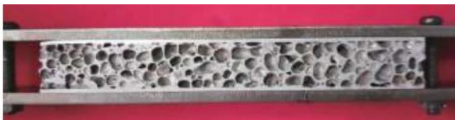
9. ábra A forrasztás során használt szerkezet [31]
