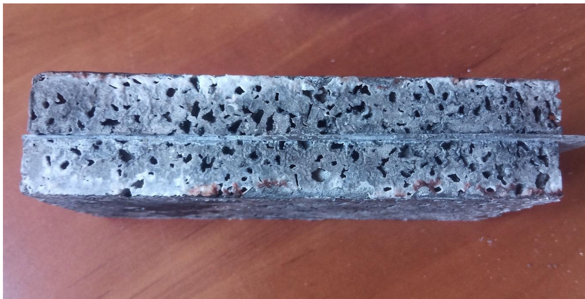
1. ábra. Keményforrasztott fémhabszerkezet
